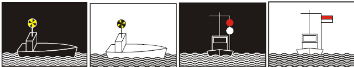
22-8. ábra. Vízi úton munkát végző, menetben levő hajó kiegészítő jelzései éjjel és nappal
