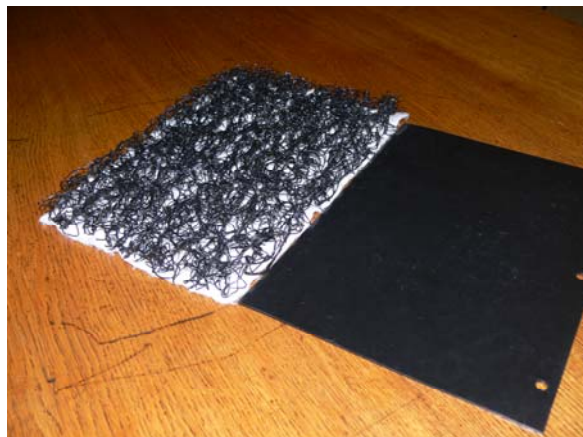
7–4. kép. Geokompozit és geomembrán
